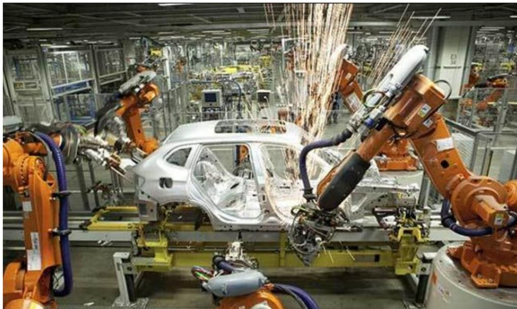
**Figura 1.2.1** Brazos robóticos completamente automatizados en una cadena de montaje de automóviles.
