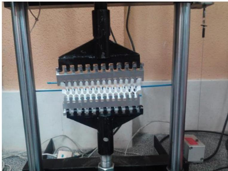
**Figura 7.4** *Ensayo a tracción. Rotura conjunto en cadena dos eslabones.*
