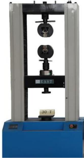
**Figura 2.1.1.2** Banco de ensayos a tracción EAST doble espacio.
