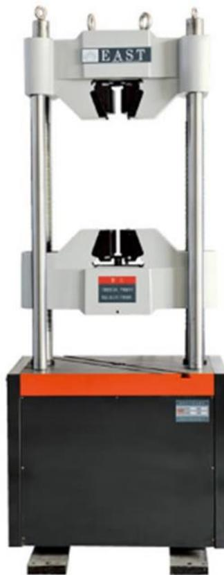
**Figura 2.1.1.1** Banco de ensayos a tracción EAST mono espacio.
