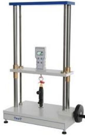
**Figura 2.1.2.3** Banco de ensayos mecánico con accionamiento manual.
