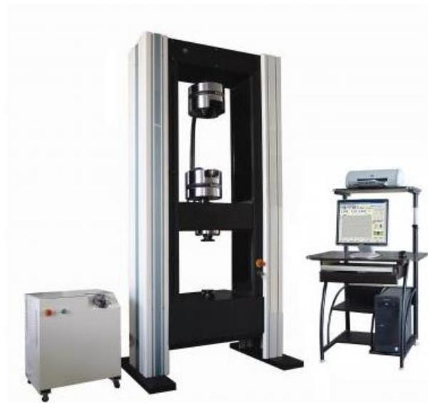
**Figura 2.1.1.3** Banco de ensayos a tracción automatizado.
