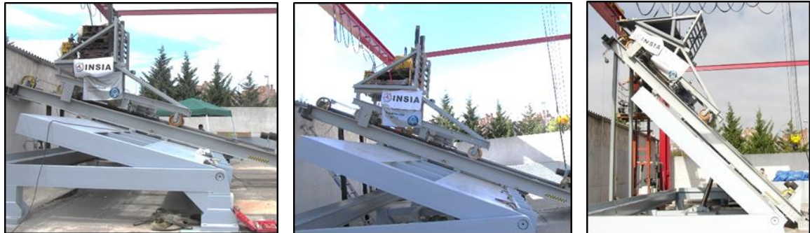
Figure 3 - Imágenes del ascensor sobre la plataforma de vuelco de INSIA con los diferentes ángulos de inclinación
