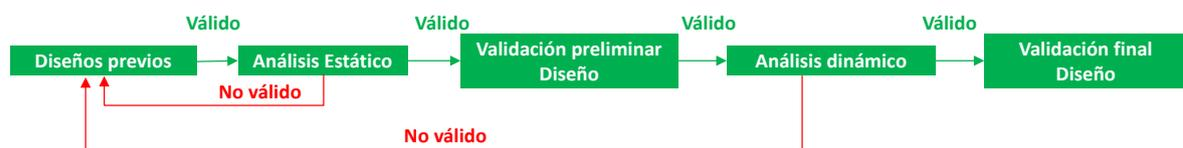
**Fig. 3 – Proceso de validación preliminar y final del diseño de un espacio urbano.**
