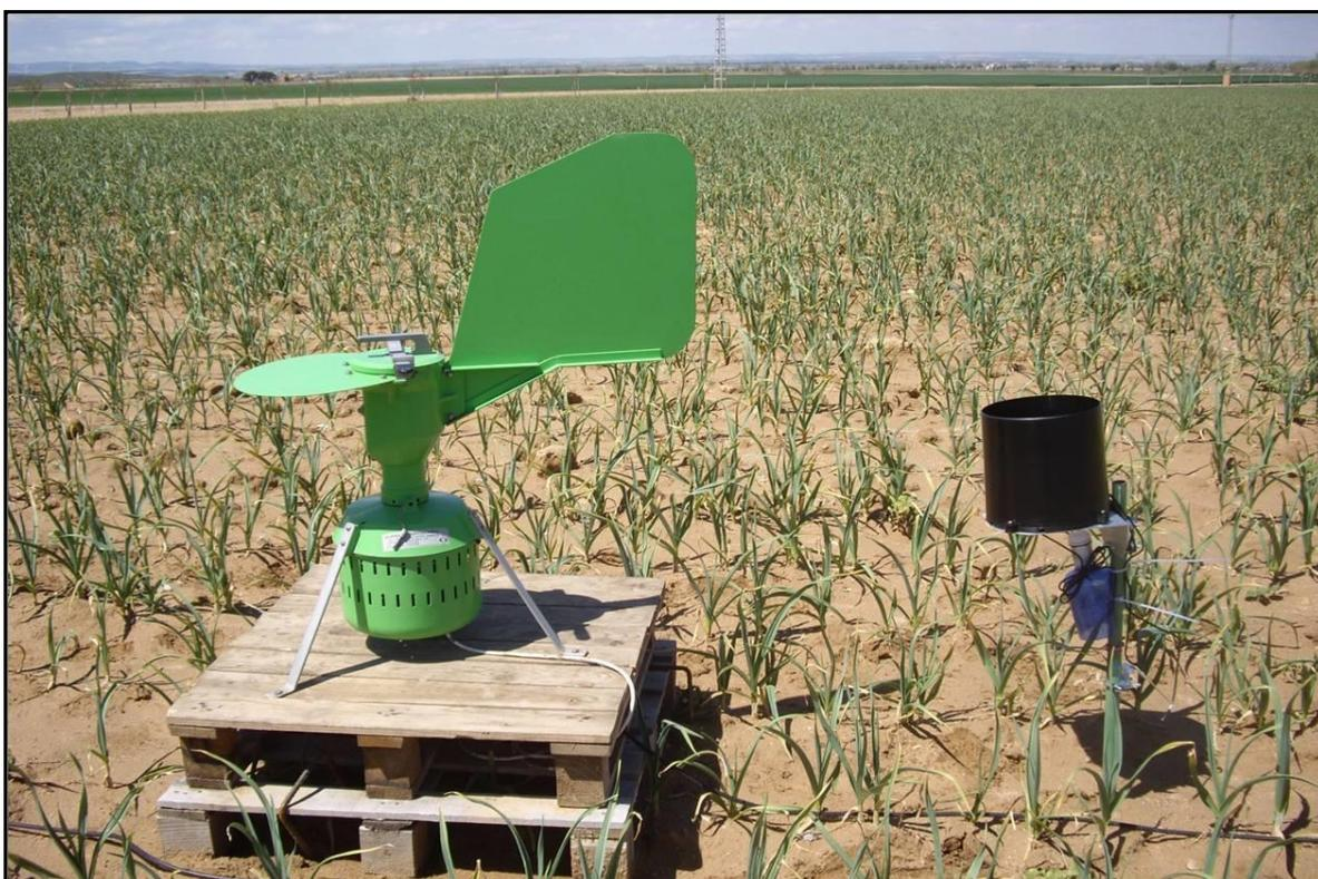
**Figura 1:** Capturador de esporas Burkard (izquierda) y estación meteorológica Watchdog (derecha).
