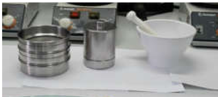
Ilustración 19. Material utilizado para el tamizado del catalizador.
