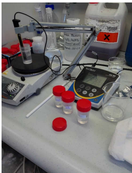
Ilustración 15. Calibración del electrodo.
