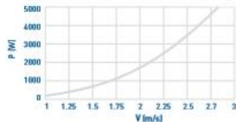
Curva de potencia obtenida durante una prueba en el Instituto GVA Potodan. Los resultados pueden variar dependiendo las condiciones del agua del río.
