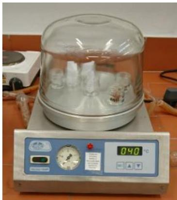
**Figura 3.4.** Imagen de la estufa de vacío empleada para el secado de las muestras
