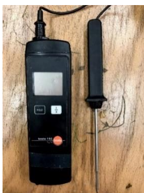
Figura 22 - Termómetro profesional Testo 110
