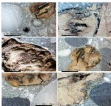
Figura 5. Micrografía de la unión Alfil-pasta de cemento y del corcho-pasta de cemento
