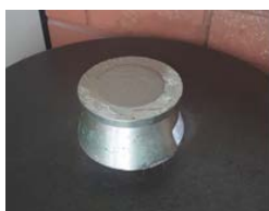
Figura 3. Molde preenchido com argamassa
