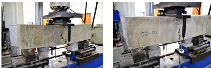
Figura 1. Ensayo UNE-EN 14651 hormigón con fibras 5D.
