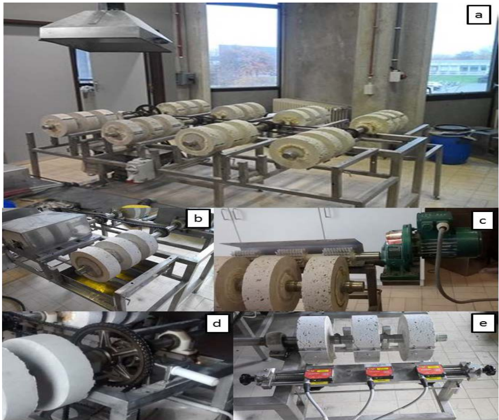
Figura 1. Equipo de ensayo de degradación ácida acelerada
