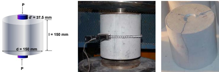
Figura 5. Ensayo de doble punzonamiento.
