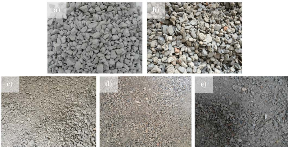
Figura 1. Áridos: a) Grava natural; b) Grava reciclada; c) Arena natural; d) Arena reciclada de hormigón; y e) Arena reciclada mixta
