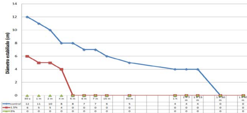
Figura 4. Trabajabilidad de los morteros con diferentes porcentajes de acelerador de fraguado. Fuente: Elaboración propia.
