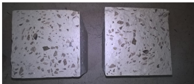
Figura 6. Detalle de la sección de rotura de la probeta prismática
