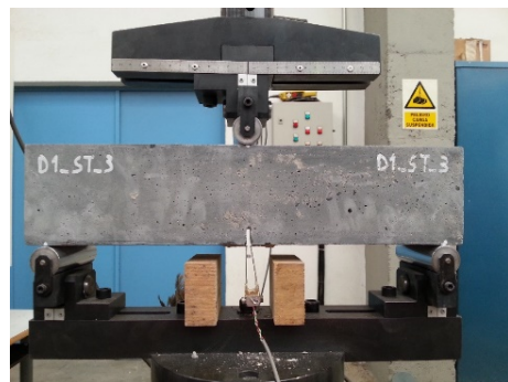
Figura 2. Configuración de los ensayos: a) dimensiones de las probetas b) ensayo estático de flexión en tres puntos con extensómetro de pinza
