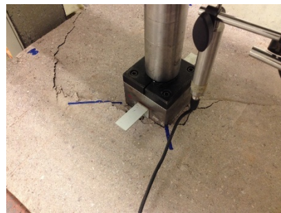
Figura 3. (a) Comparación de la medición de la deflexión central respecto de la cara inferior (línea roja) y superior (línea azul) del panel; (b) Falla por cortante por punzonamiento observada en paneles con cuantías de fibras medias y altas.
