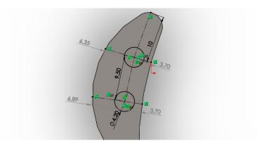
A continuación, se les da a los agujeros una salida hacia la cara interna de la guía de 2,6mm de ancho, siendo la broca con la que se perfora de 2mm de diámetro, para que se pueda extraer con facilidad.
