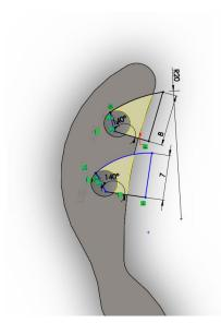
Con el fin de facilitar la extracción de la guía una vez se ha perforado con la broca, se crea una salida curva de radio 20mm, que es tangente al agujero de túnel a 140° de la salida original. Con esto se ayuda a que la guía sea extraída de forma cómoda y natural, sin necesidad de esfuerzo.
