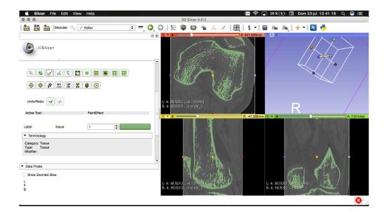
14. El interior del hueso es poroso e irregular. Con el fin de optimizar su posterior impresión, se decide volverlo macizo. Para ello, se amplia una de las vistas, concretamente la vista de planta, para obtener más precisión en la obtención de las paredes condilares. Para convertirlo en un modelo macizo, se tratan una a una las sucesivas imágenes de esta vista. Con la herramienta *Brush*, se pintará el interior del contorno seleccionado por la herramienta *ThresholdEffect*.
