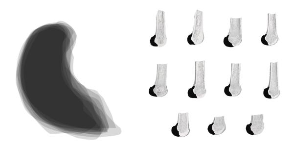
Tras analizar la geometría, se obtiene que el radio interno medio de la muestra es 38 milímetros, mientras que el radio interno medio oscila entre 26 y 29 milímetros. A continuación, se coloca virtualmente la guía sobre el área media de los cóndilos, tal y como lo haría el cirujano. A partir de ésta información, junto con la localización de los puntos de túnel hallada previamente, se se define dónde debería de localizarse el túnel en la guía, a 19.5mm de la cabeza de la guía.
