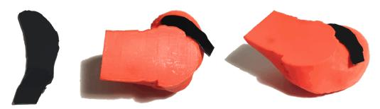
A través de una sucesión de guías que cada vez se adaptan mejor a la geometría del hueso, se llega a una solución optima para todos los modelos de cóndilo impresos. Ésta se apoya en la pared interna del hueso, y cubriendo la superficie y sosteniéndose correctamente en todos los casos. Por tanto, queda definida la forma preliminar de la guía para operación de LCA.
