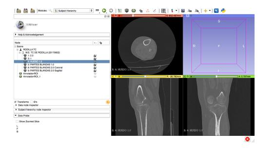
5. Con la vista elegida cargada, se selecciona el módulo *Volume Rendering*. Este módulo permite seleccionar partes del modelo .DICOM en función de su densidad.
