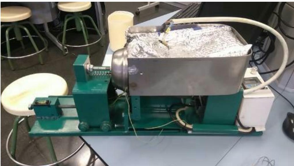
*Ilustración 24 prototipo para los ensayos de rotomoldeo.*
