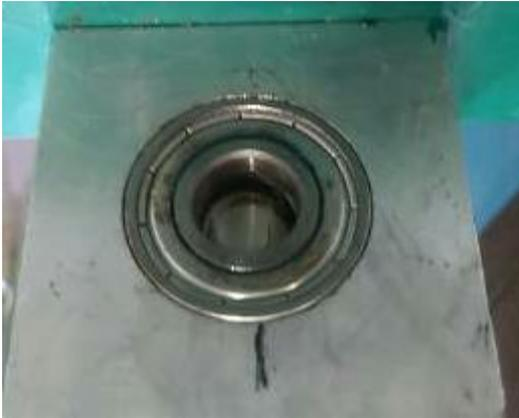
*Ilustración 11 resultado del alojamiento del rodamiento realizada por Control numérico.*
