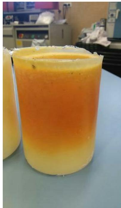
*Ilustración 25 moldeo con exceso de curación.*
