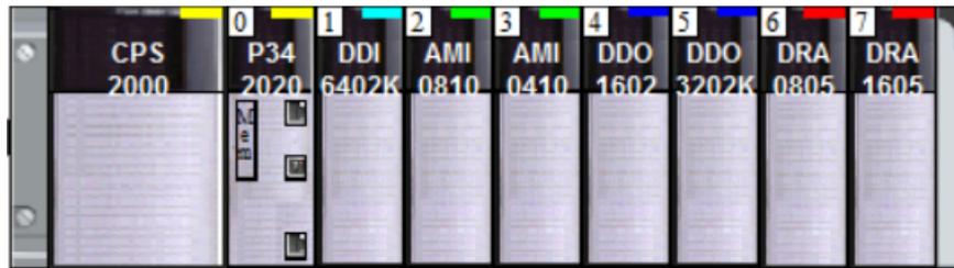
Ilustración 3. PLC Modicon M340 con montaje completo de slots.
