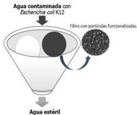
FIGURA 2. Esquema del proceso de filtración de agua a través del lecho de partículas funcionalizadas con componentes activos de aceites esenciales.
