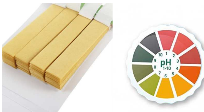
Ilustración 31: Tiras de indicador universal (izquierda) y colores que muestran según la característica del medio según [8].
