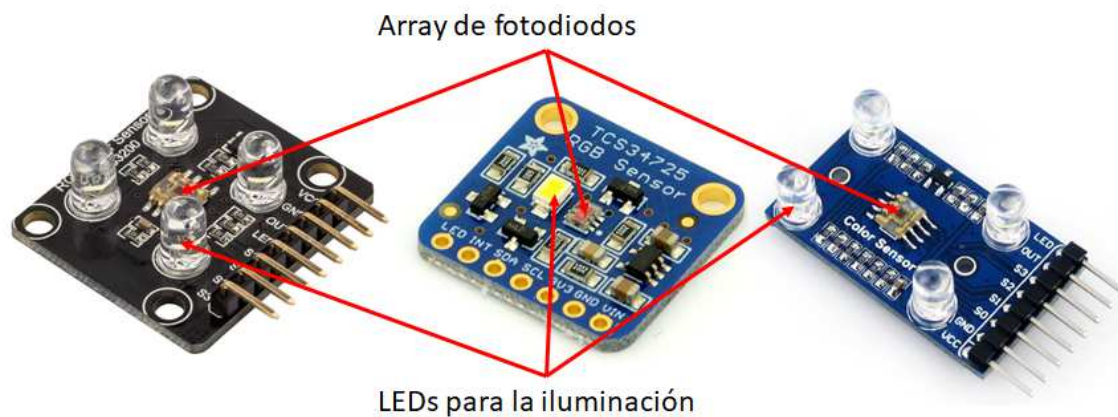
Ilustración 7: Tres modelos distintos de sensores RGB y sus partes más importantes, adaptado de [18].
