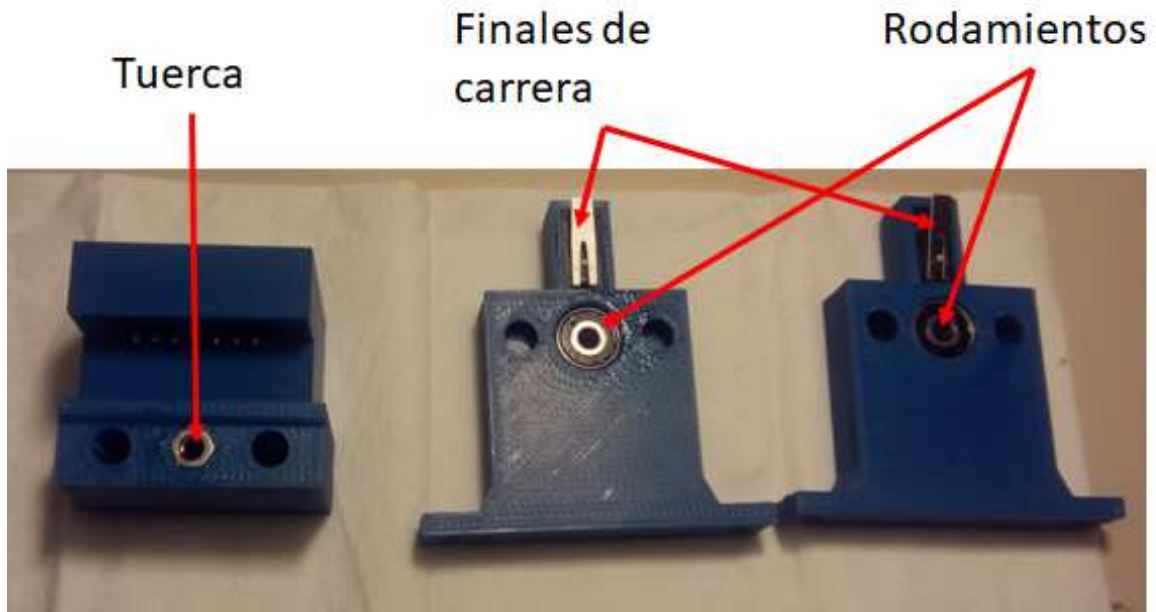
Ilustración 110: Plataforma con soporte para el sensor y soportes de las guías con rodamientos y finales de carrera.
