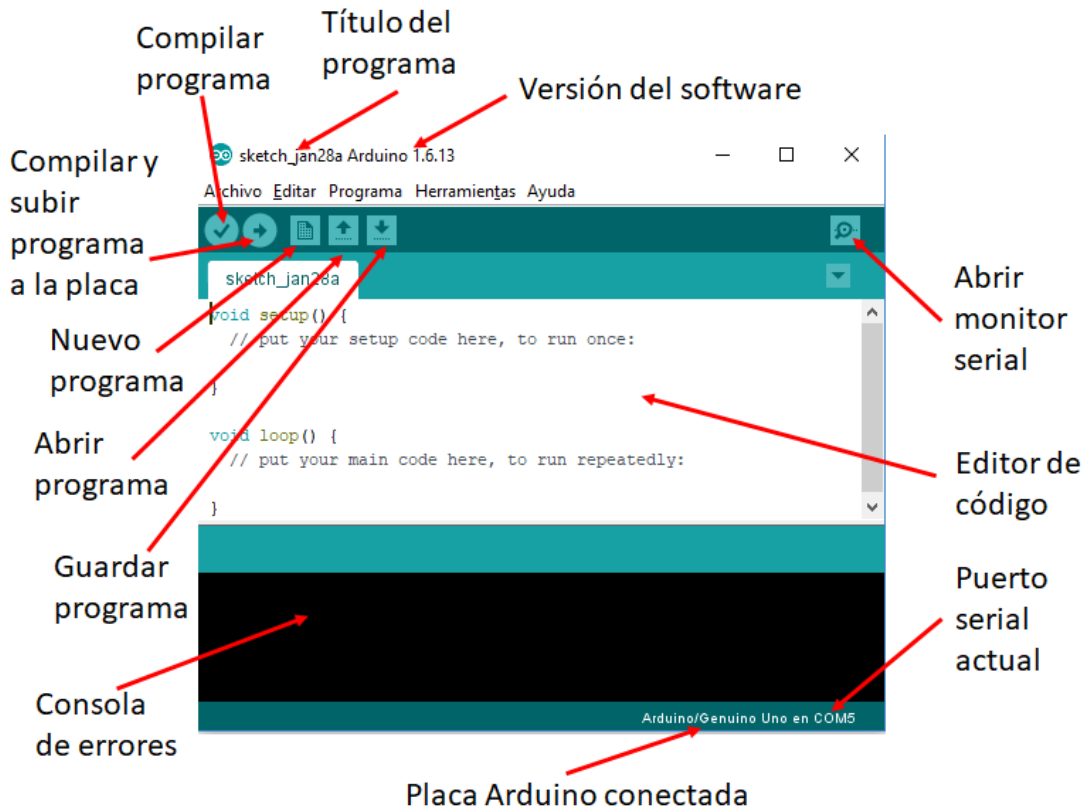
Ilustración 52: IDE de Arduino con algunas de sus partes según [45].
