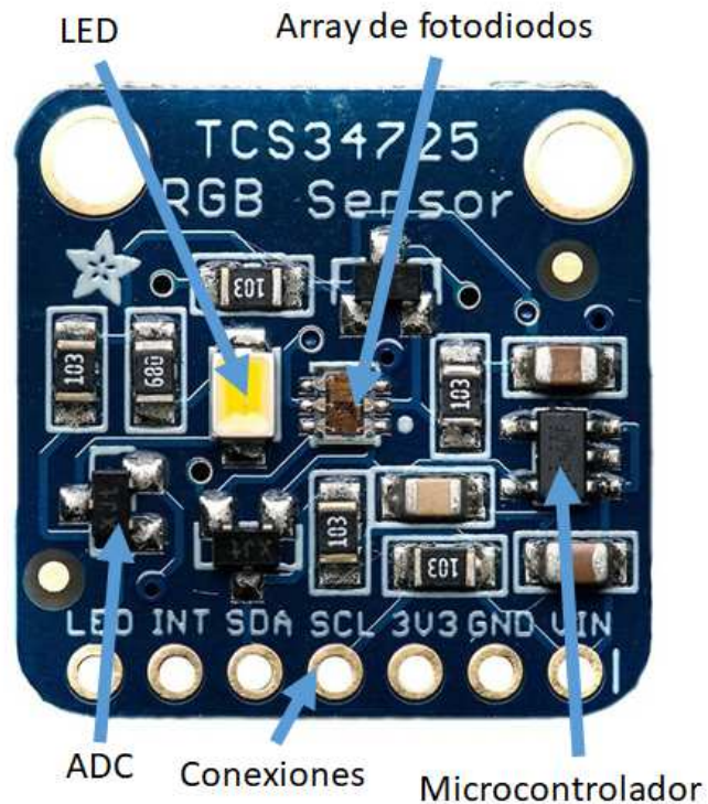
Ilustración 32: Sensor TCS34725 y algunas de sus componentes a partir de [17].
