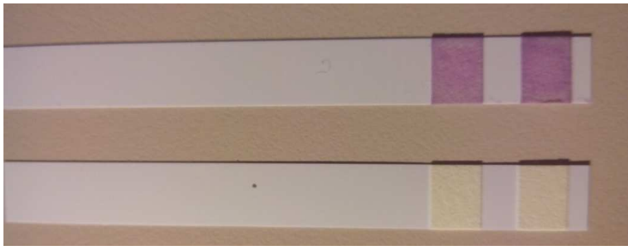
Ilustración 180: Tiras reactivas para la determinación de nitratos tras ser sumergidas en una solución con nitratos (arriba) y sin nitratos (abajo).
