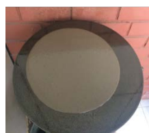
Figura 4. Argamassa após espalhamento
