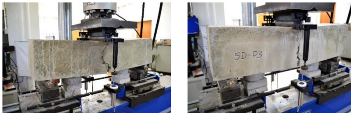
Figura 1. Ensayo UNE-EN 14651 hormigón con fibras 5D.
