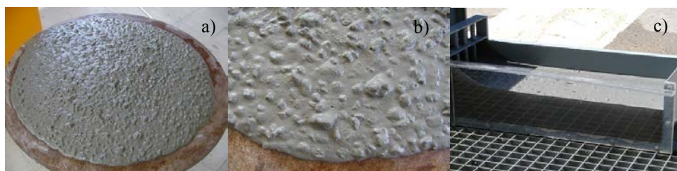
Figura 1. Auto-compactibilidade da mistura Ref, (a) - Ensaio de espalhamento; b) - pormenor do bordo do ensaio de espalhamento e c) - Ensaio na caixa L
