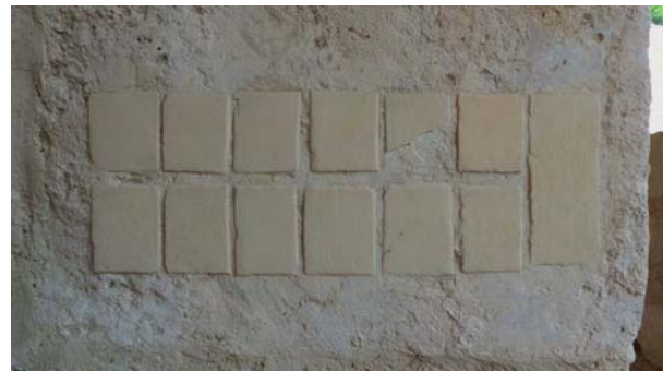
Figura 5. Probetas expuestas sobre el soporte pétreo, antes de ser ensayadas.
