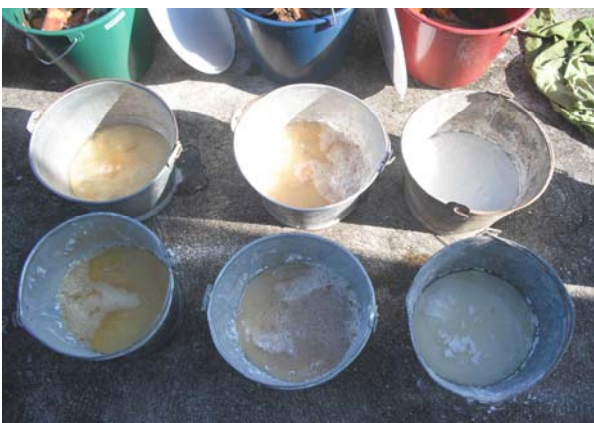
Figura 4. Apagado de la cal viva mediante inmersión en el agua de las cortezas.
