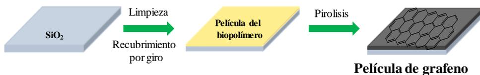
**Esquema 1.11.** Procedimiento de preparación de películas de grafenos defectuosos y dopados con nitrógeno mediante la pirólisis de películas de polisacáridos naturales (ej. alginato o quitosano) depositadas sobre sustratos arbitrarios (ej. cuarzo) mediante la técnica de recubrimiento por giro.
