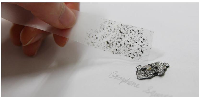
**Figura 1.11.** Fotografía de una cinta adhesiva con NPs de grafito obtenidas tras la exfoliación del grafito.
