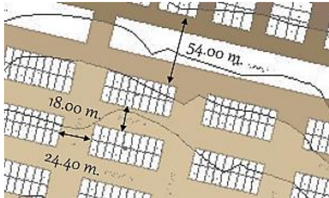
Imagen 140 Dimensiones de vías en el Asentamiento Humano Techo propio el Mirador, Ventanilla - Lima. Fuente: Elaboración propia
