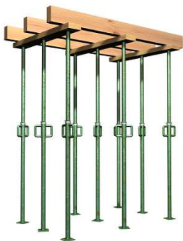
Imagen 08: Apeo simple (apuntalamiento).
