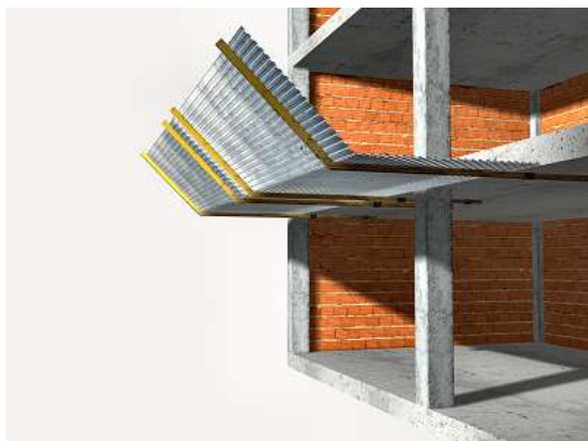
Imagen 70: Gráfico de una marquesina ubicada en la fachada de una fachada de obra nueva. La marquesina es un elemento de seguridad a terceros.
