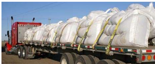
Imagen 18: Transporte de sacas de grava. Este material se puede utilizar para ejecutar el lastre de un estabilizador de fachada.
