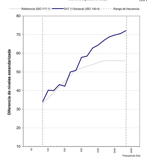
Evaluación basada en resultados de medidas in situ obtenidos mediante un método de ingeniería
