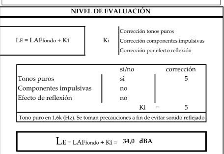
Punto 6: Nivel sonoro debido a los equipos de aire acondicionado del local en lavadero vivienda 1 bloque 67 planta 1<sup>a</sup>.
