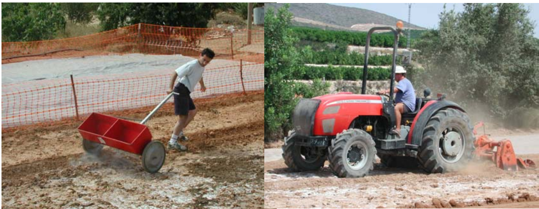
Fotografia 14. Estri de distribució del basamid (esquerra) i rotocultivadora per a la incorporació del producte (dreta).
