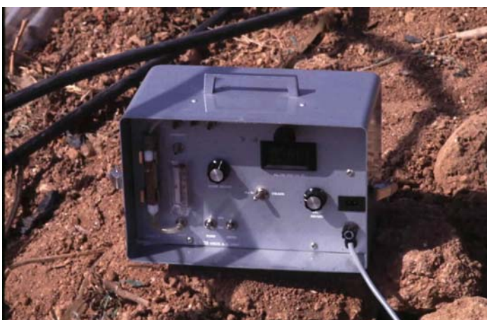
Fotografia 9. Aparell de mesura de la concentració de BM en l'aire, Fumiscop.
