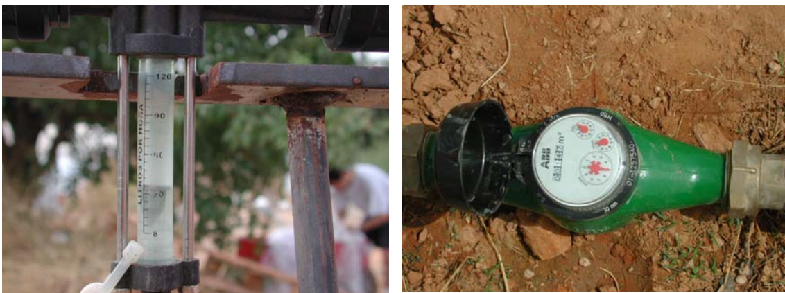
Fotografia 13. Injecció amb Venturi dotat amb cabalímetre (esquerra) i comptador d'aigua (dreta).
