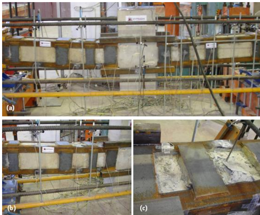
Fig. 2.25. Rotura de probetas tipo T. (Garzón-Roca et al., 2011b). a) foto general del ensayo. b) zona de rotura c) aplastamiento del hormigón por compresión y abolladura de los angulares.
