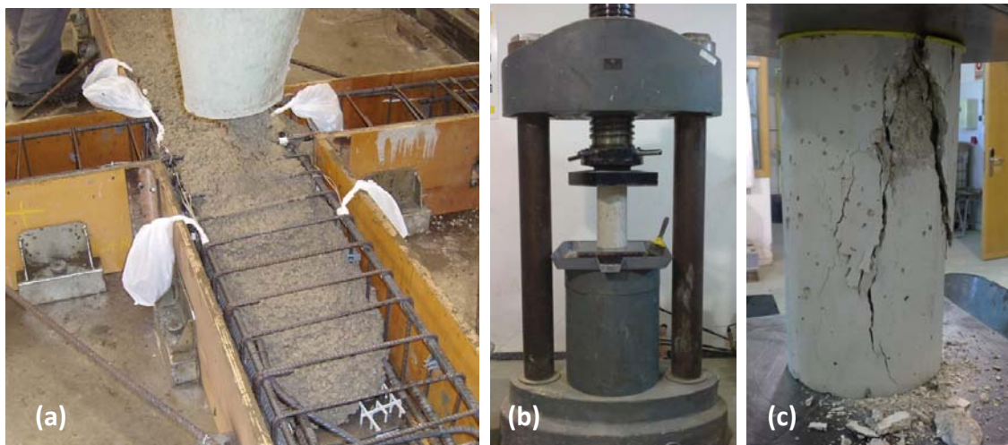
Fig. 3.7. a) Vertido de hormigón en probeta. b) prensa hidráulica para ensayo de compresión. c) rotura a compresión de probeta cilíndrica.
