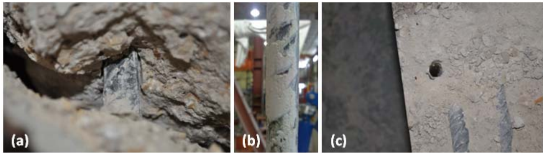
Fig. 6.5. Adherencia armadura de pilar. Probeta S.DB.L0: a) fisura durante la flexión del pilar, b) arrastre de material por deslizamiento de la armadura, c) orificio en el nudo tras la extracción de la armadura del pilar
