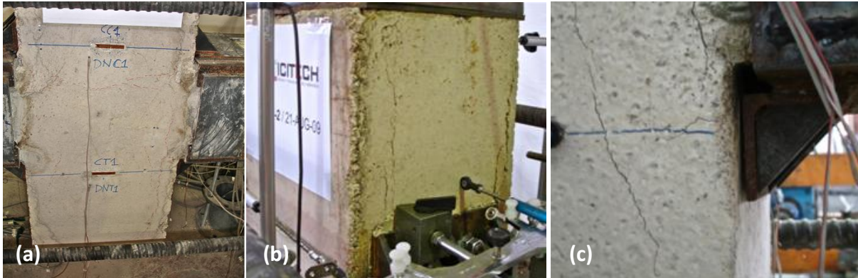
Fig. 2.27. Rotura de probetas tipo A (Garzón-Roca et al., 2011a). a) foto frontal del nudo. b) fisuras de compresión del nudo en zona superior, con penetración del capitel en el hormigón. c) fisura de tracción por cono de arrancamiento del taco químico.
