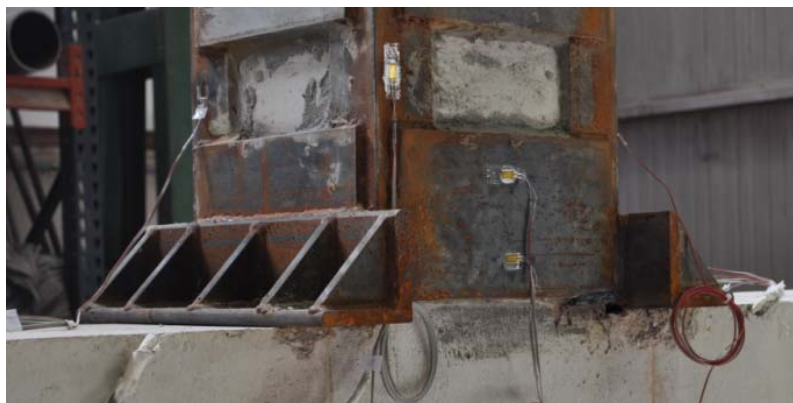
Fig. 3.24. Galgas extensométricas en refuerzo exterior de soportes
