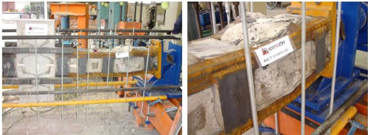
Fig. 2.17. Modo de rotura de la probeta AxL.T (Adam 2007), Adam et al. (2008a; 2008b)
