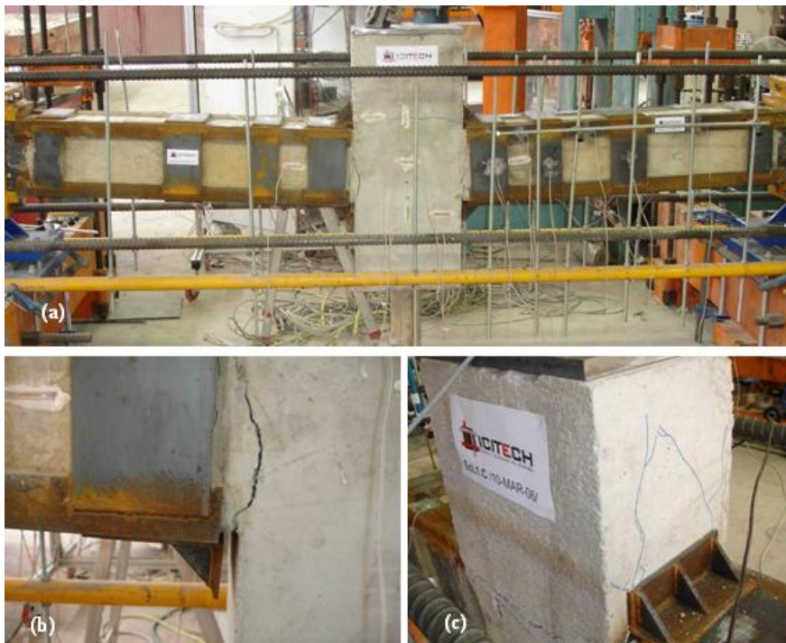
Fig. 2.24. Rotura de probetas tipo C. (Garzón-Roca et al., 2011b). a) foto general del ensayo. c) fisura de tracción en cara inferior de la probeta, con despegue del capitel. c) fisuras de descompresión del nudo en zona superior comprimida, con penetración del capitel en el hormigón.
