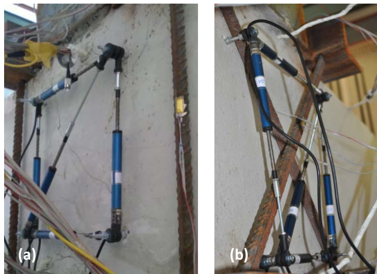
Fig. 3.26. Captadores de desplazamiento colocados para medir la distorsión del nudo. a) probeta reforzada con barras verticales, b) probeta reforzada con barras diagonales
