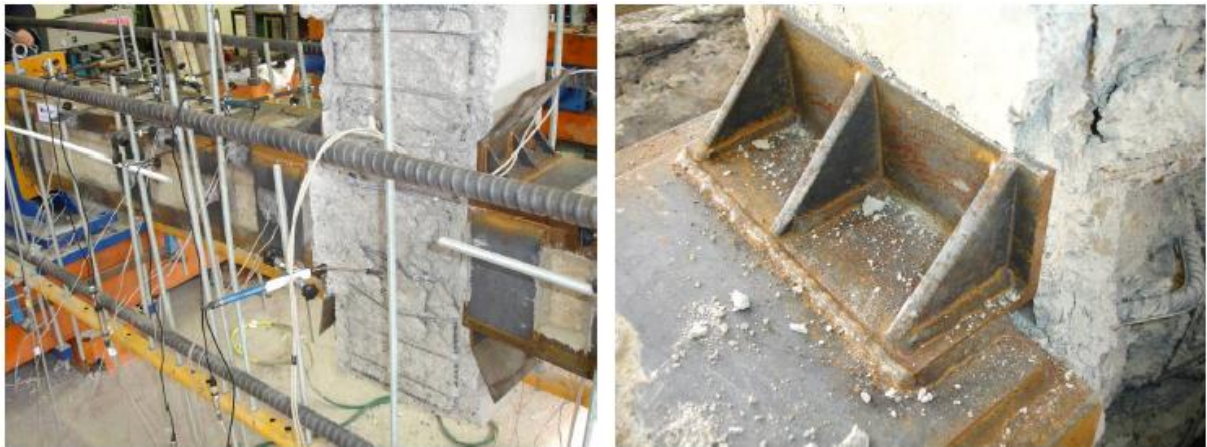
Fig. 2.16. Modo de rotura de la probeta AxL.C (Adam 2007), Adam et al. (2008a, 2008b)
