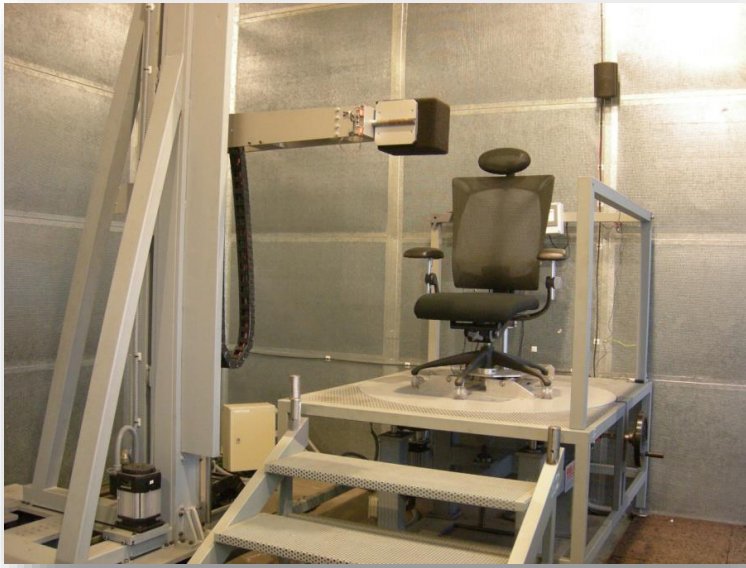
Figura 1.4 La cámara anecoica con bajo nivel de reverberación y sistema robótico. Las paredes y el suelo de la sala están cubiertas con cuñas que absorben el sonido. El sistema robótico conjunto puede ser movido para colocar el altavoz en cualquier ubicación en radio de 5 metros. Una silla para el maniquí se representa en una plataforma fija.
