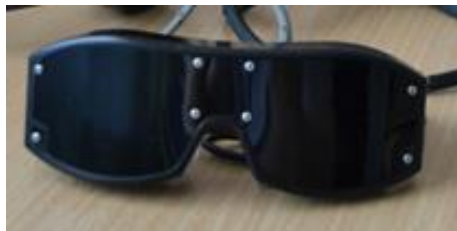
Figura 1.5 Imagen real con los elementos del sistema: gafas (elemento sensor 1x64 pixeles del láser miniaturizado e integrado).
