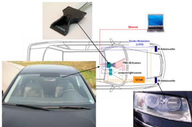
Figura 1.6 Coche de prueba con una cámara PMD para seguridad de los peatones y la detección de Pre-colisión, respectivamente [12].
