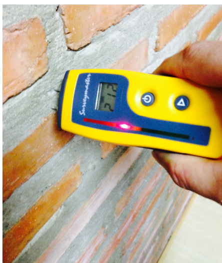
Fig. 3.23. Humidímetro en modo conductivo. Utilizado en esta investigación. Propiedad del autor. Fuentes propias
