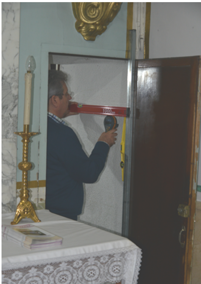
Fig. 5.22: Dificultad de movimientos en una toma de datos, utilizando el regle de control subdividido y como complemento un nivel de burbuja de 1m grafiado con escala numérica. Investigación realizada con este procedimiento. Puerta de acceso desde la Iglesia a la Casa Abadía. Iglesia de Ntra. Sra. de la Encarnación de Náquera. Valencia. Ver Cap. 9.1. Fuentes propias.
