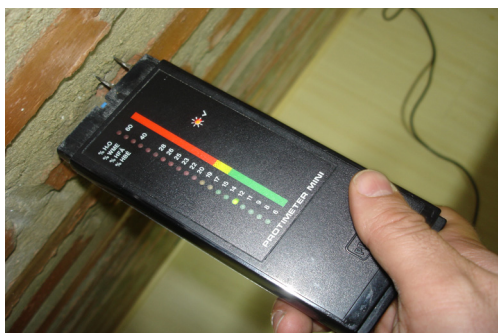
Fig. 4.3. Medidor humidímetro PROTIMETER MARK IV. Propiedad y Foto del autor.
