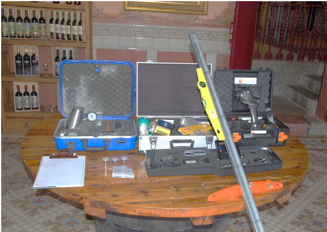
Fig. 6.1: Equipo completo de control utilizado en esta investigación: humidímetro, regle grafiado, niveles de burbuja, cámara térmica, taladro, maletín de dispositivo de carburo de calcio, higrómetro, termómetro ambiental y de superficie, maza, cincel, recipientes para tomas, cepillo, lienza, clavos acerados, detector de sales, herramientas varias, etc.. Foto tomada durante la investigación realizada en el edificio de las Bodegas Torre Oria en Requena, Valencia. Fuentes propias.
