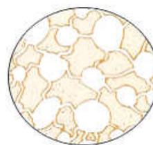
Figura 3.3.b. Representación ideal de una porosidad interna. Dibujo cedido por HUMICONTROL S.L.
