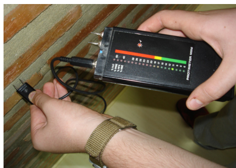
Fig. 4.3. Medidor humidímetro PROTIMETER MARK IV. Propiedad y Foto del autor.
