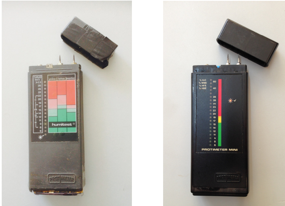
Fig. 5.13: Humidímetros con escala paralela de conversión: fsd (full scale deflection). Izquierda: Dispone de tres escalas de equivalencia: yeso, mortero, hormigón, cada una con su equivalencia a rojo amarillo y verde. Destacar la subdivisión en los mismos colores pero más claros, a modo indicativo de zona de riesgo en la misma zona. Dispositivo del autor de esta investigación que data de 1985. Derecha: con una escala numérica indicativa de % WME y escala equivalente a materiales de construcción en rojo, amarillo y verde. Foto fuentes propias.
