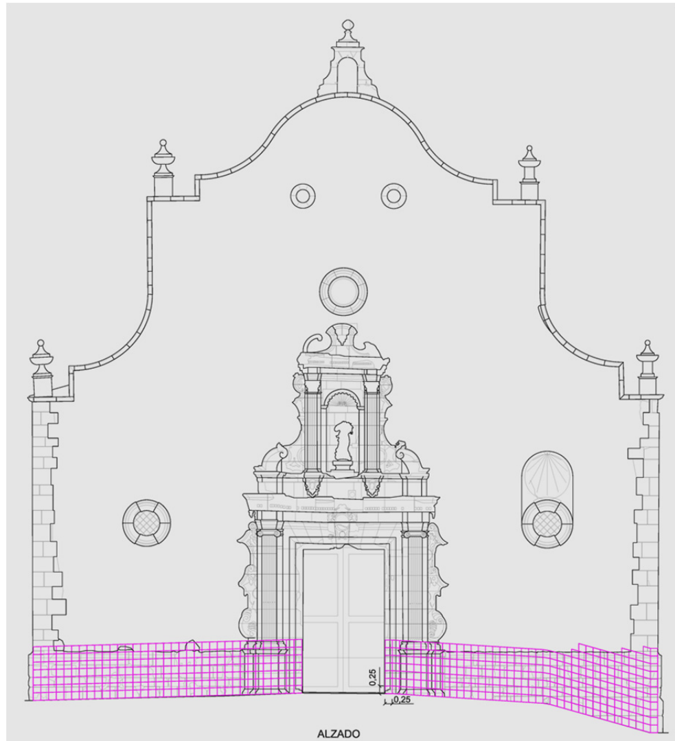
Fig. 5.9: Fachada Iglesia de la Inmaculada, Arcos de las Salinas, Teruel. Investigación realizada con este procedimiento. Malla dibujada perimetralmente a las piezas que sobresalen, sobre base no horizontal la malla gira hacia abajo según la pendiente de la base. Fuentes propias.
