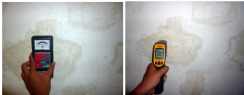
Fig. 4.18. Medición de control de temperatura y humedad superficial por puntos. (Hanif, Othuman Mydin, & Utaberta, 2015)
