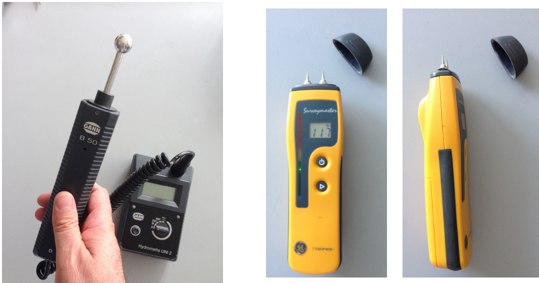
Fig.3. 24. Izqda. Humidímetro de bola GANN. Derecha: humidímetro Protimeter con posibilidad de modo capacitativo, “búsqueda” (parte trasera abultada) y modo conductivo: pins. Instrumentos utilizados en esta investigación, propiedad del autor. Fuentes propias.
