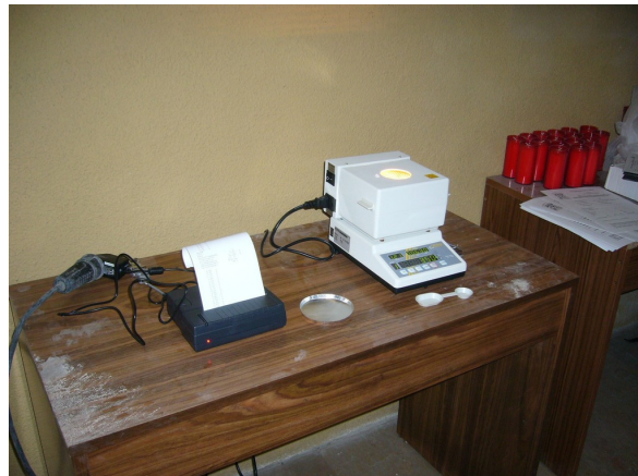
Fig. 3.20: Analizador halógeno de humedad según el principio termogravimétrico. Transportable. Izda.: dispositivo Mettler Toledo. Foto catálogo Mettler Toledo España. Dcha.: Sencillo montaje de laboratorio en obra para análisis directo in situ. Foto gentileza de HUMICONTROL, S.L.
