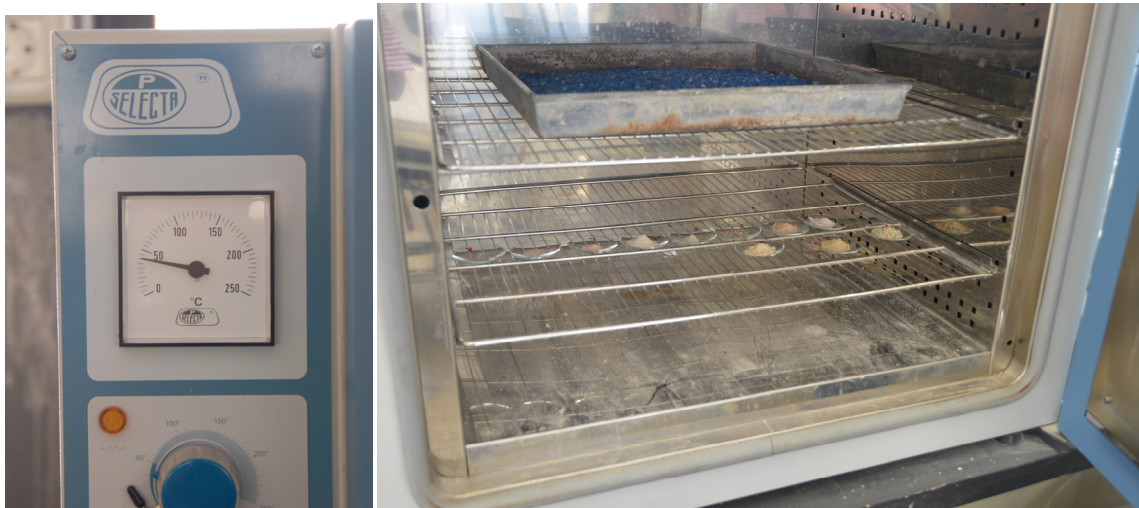
Fig. 3.21: Estufa de laboratorio para secado de muestras utilizada en esta investigación. Laboratorio de Materiales de Construcción, ETSIE, U.P.V. Fuentes propias.
