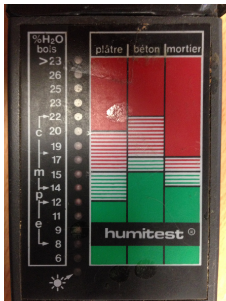
Fig. 3.26. Línea de leds marca a la izquierda su valor en %WME y a la derecha en una tabla de conversión el valor de humedad equivalente en yeso, hormigón y mortero. Humidímetro Protimeter Humitest, propiedad del autor. Fuentes propias.
