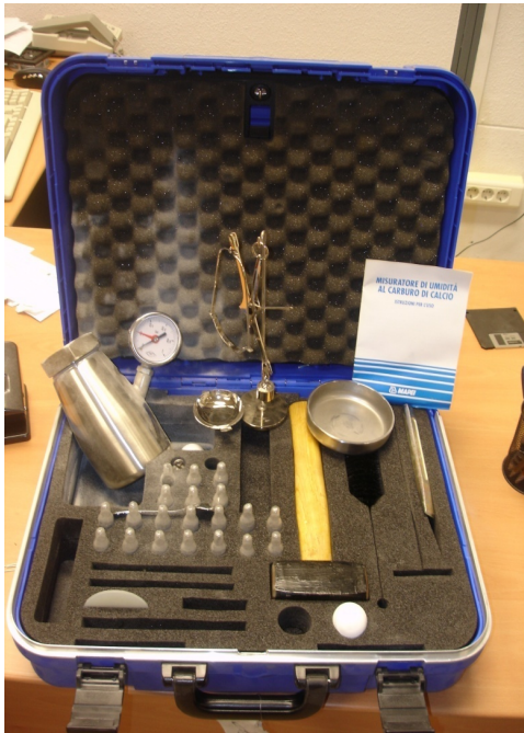
Fig. 3.22. Maleta para transporte de equipo para análisis con carburo de calcio. Utilizada en esta investigación, propiedad del autor. Fuentes propias
