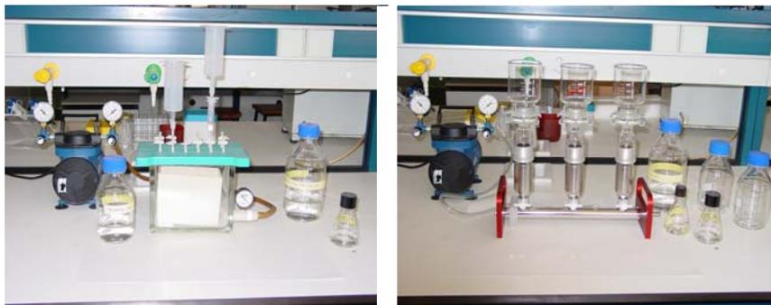
Figura IV.6. Mesa de extracción a vacío Alltech™ para cartuchos de SPE (izquierda). Sistema de extracción para discos 3M™ Empore® (derecha).
