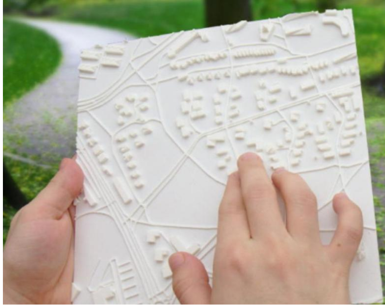
Figura 16. Mapa táctil generado mediante impresión 3D para personas con discapacidad visual. Fuente: Impresoras3D.com (s. f.). Consulta: 29/04/2025.
