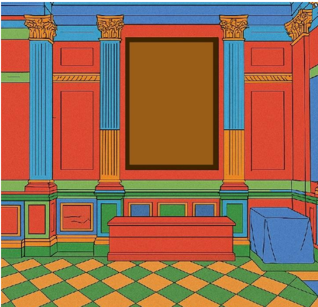
Figura 7. Análisis estratigráfico cromático de la fachada izquierda de la Capilla de San Francisco de Borja. Parte del estudio de diagnóstico visual del estado superficial de los muros. Fuente: elaboración propia.
