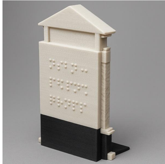
Figura 52. Prototipo altar central impresión 3D con letras en braille al reverso Fuente: elaboración propia
