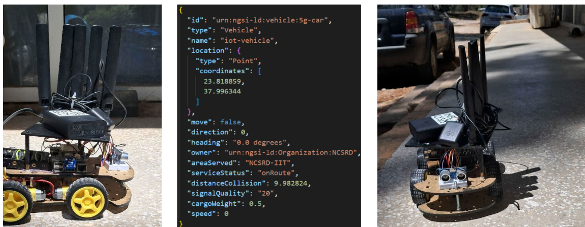
Figura 6.6: Vehículo IoT utilizado en el demostrador de aerOS junto con la entidad NGSI-LD que lo representa
