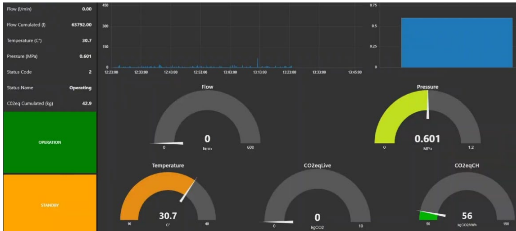
Figura 6.23: Monitorización de las condiciones ambientales sobre las que operan las máquinas de la planta de SIPBB
