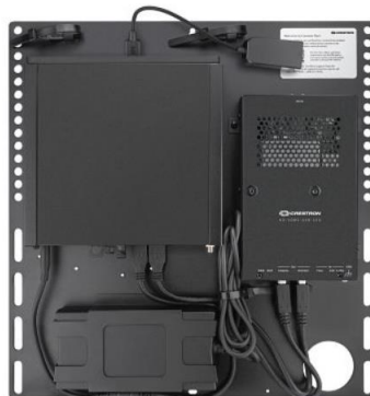
Figura 24. PC núcleo y convertidor HD-USB del sistema.
