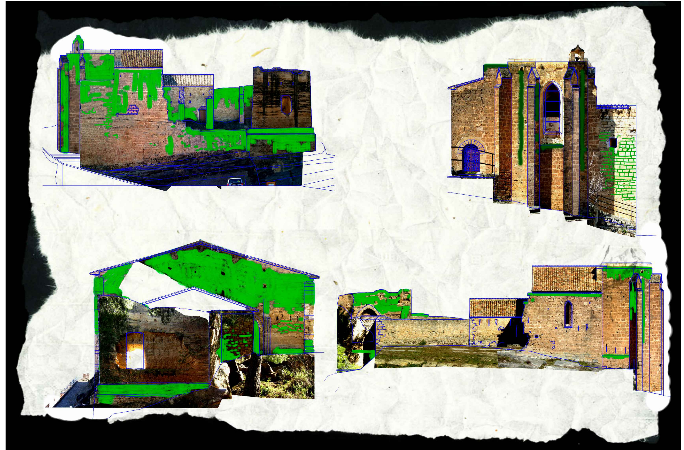
Distribución de los ennegrecimientos en todo el conjunto arquitectónico.
