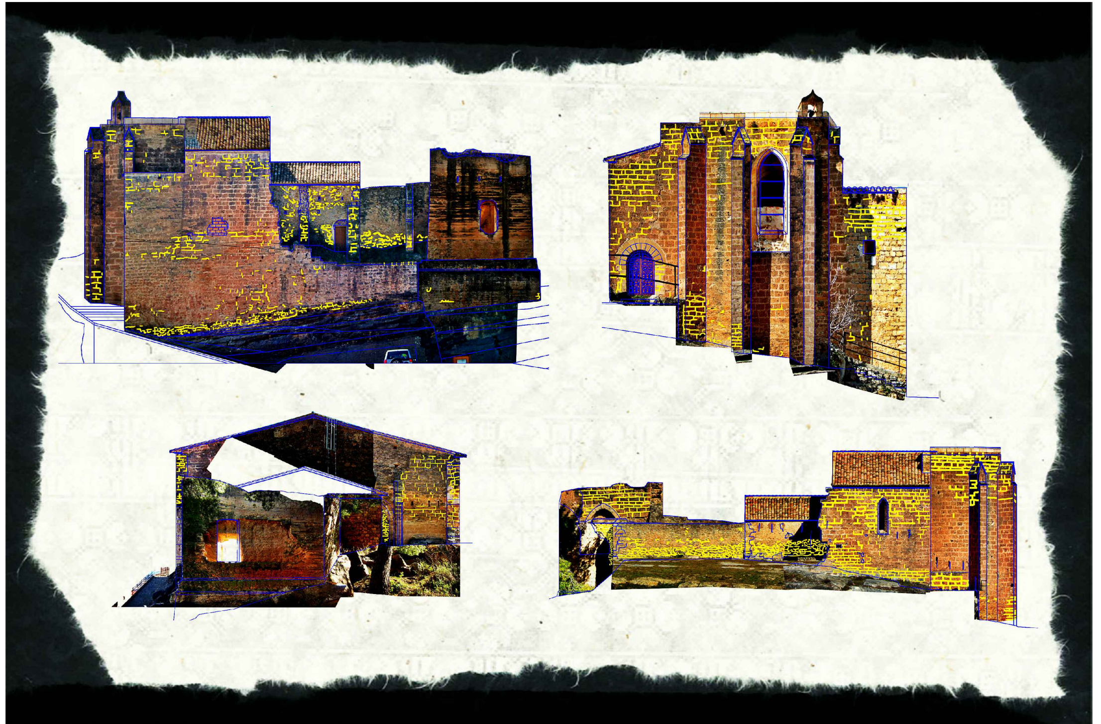
Distribución de los vaciados de juntas en todo el conjunto arquitectónico.
