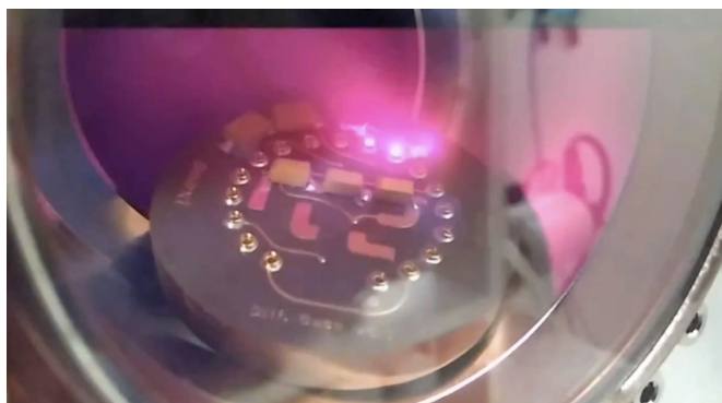
Figura 4.7: Momento en que salta chispa en la base
