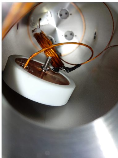
Figura 4.2: Vista del interior de la vasija donde se realizaron los test de temperatura de la base, antes de conectar el cable del sensor de temperatura y la trenza metálica.
