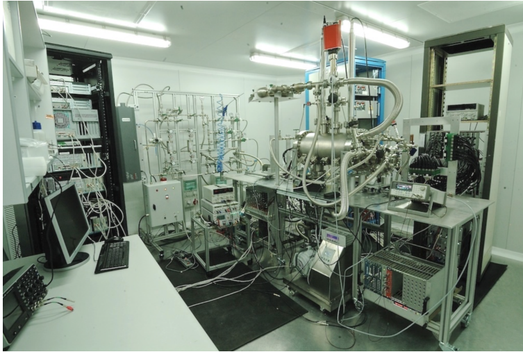
Figura 1.8: El detector NEXT-DEMO y los sistemas auxiliares (sistema de gas, componentes electrónicos frontales y DAQ) en su ubicación en la sala semi-limpia en IFIC.
