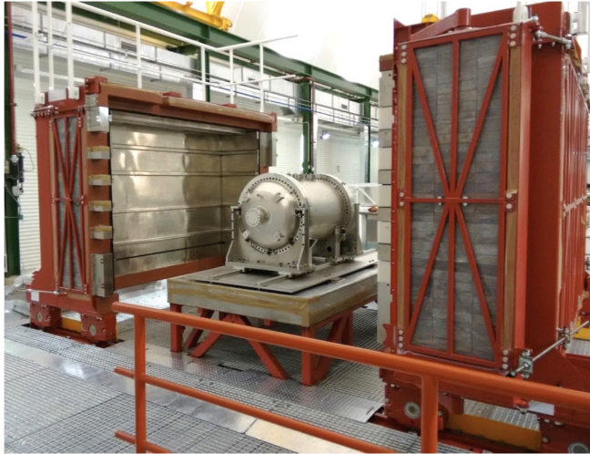
Figura 1.28: Castillo de plomo del experimento NEXT. El detector NEW antes de la instalación de tuberías y cableado.
