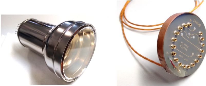
(a) Uno de los PMTs R11410-10 de Hamamatsu. (b) Base de Kapton rellena con epoxy térmica radiopura.
