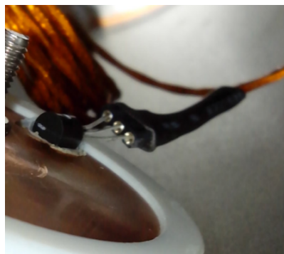
(b) Detalle del sensor de temperatura conectado a la base.
