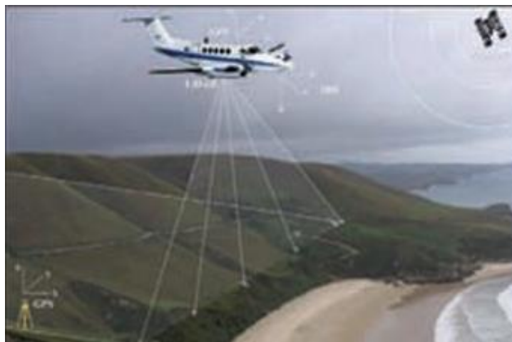
Imagen 30 : Proceso de captura de datos LIDAR desde aeronave, mediante pulsos láser dirigidos al terreno. (MITECO, 2021).
