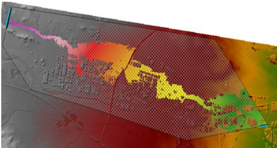
Imagen 75 : Elevación máxima de la lámina de agua (WSE máx.) para el período de retorno 25 simulada con el MDT2, con visualización del perímetro 2D. (propia, 2025).
