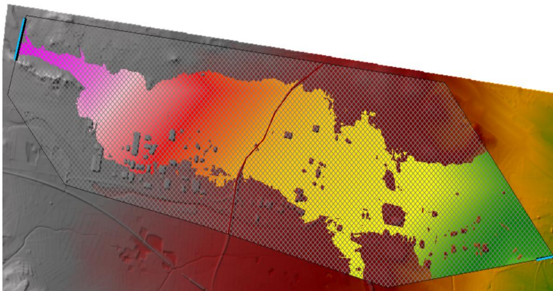
Imagen 61 : Elevación máxima de la lámina de agua (WSE máx.) para el período de retorno de 500 años, simulada con el MDT1 y visualización del perímetro 2D. (propia, 2025).
