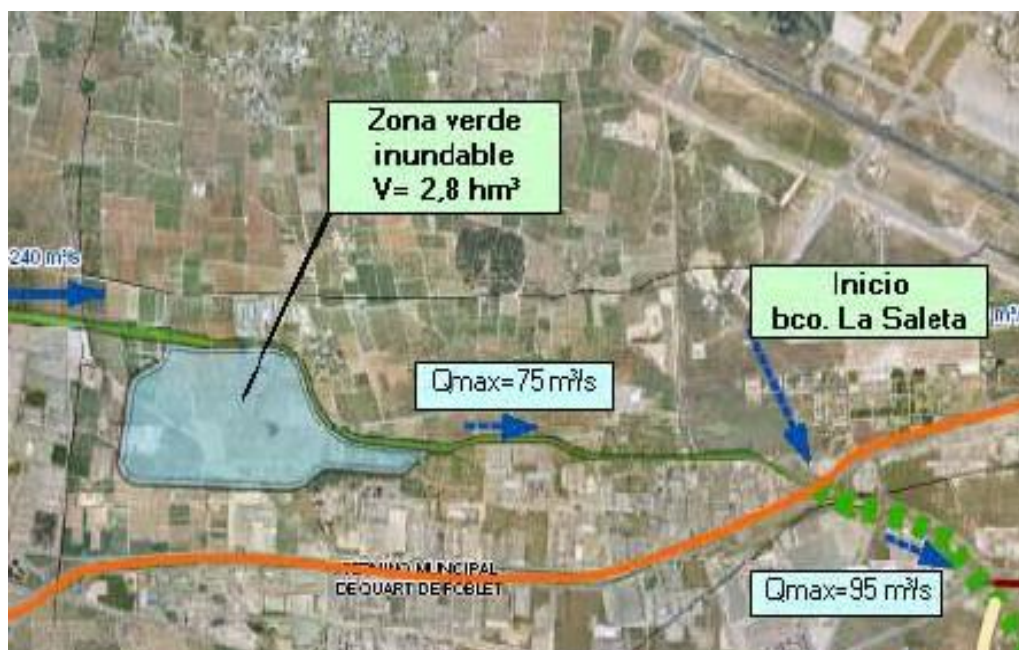
Imagen 32 : Representación esquemática de caudales máximos y zona inundable en el barranco de la Saleta. (Júcar, Estudio del comportamiento hidráulico e inundabilidad del barranco de la Saleta. Universitat Politècnica de València).
