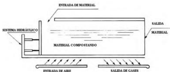
Figura 13. Contenedor de lecho de sólidos estáticos. Fuente: https://ecommons.cornell.edu/items
