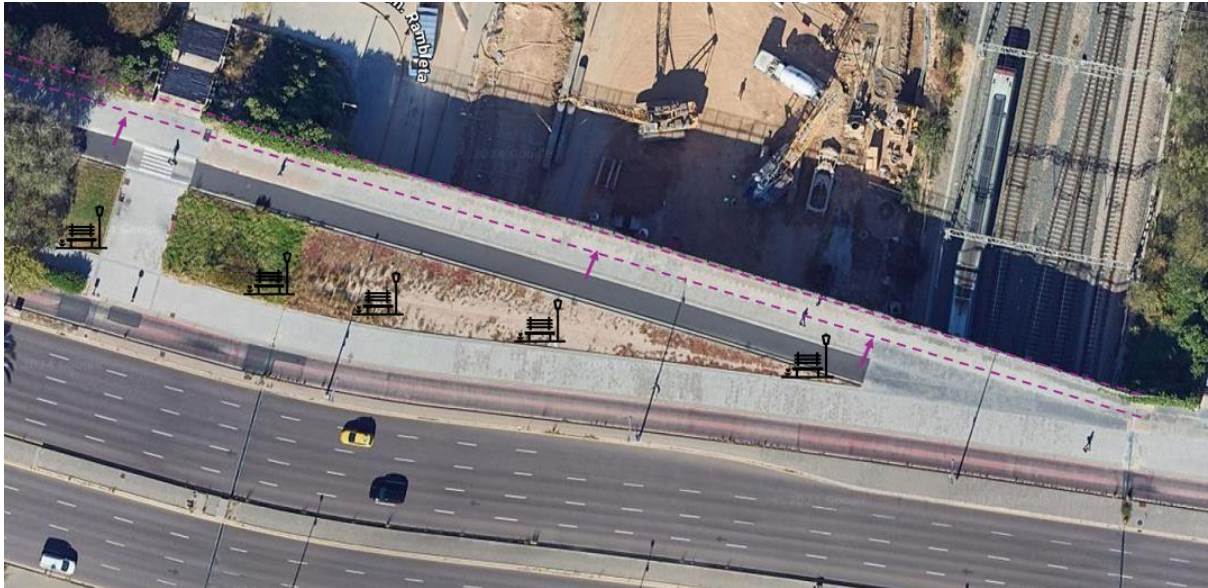
Diagrama 1 Desplazamiento carrilbici e instalación puntos de descanso.
