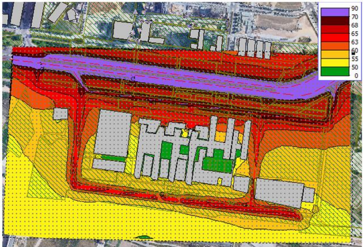
Ilustración 19: Resultados de la simulación del software Predictor
