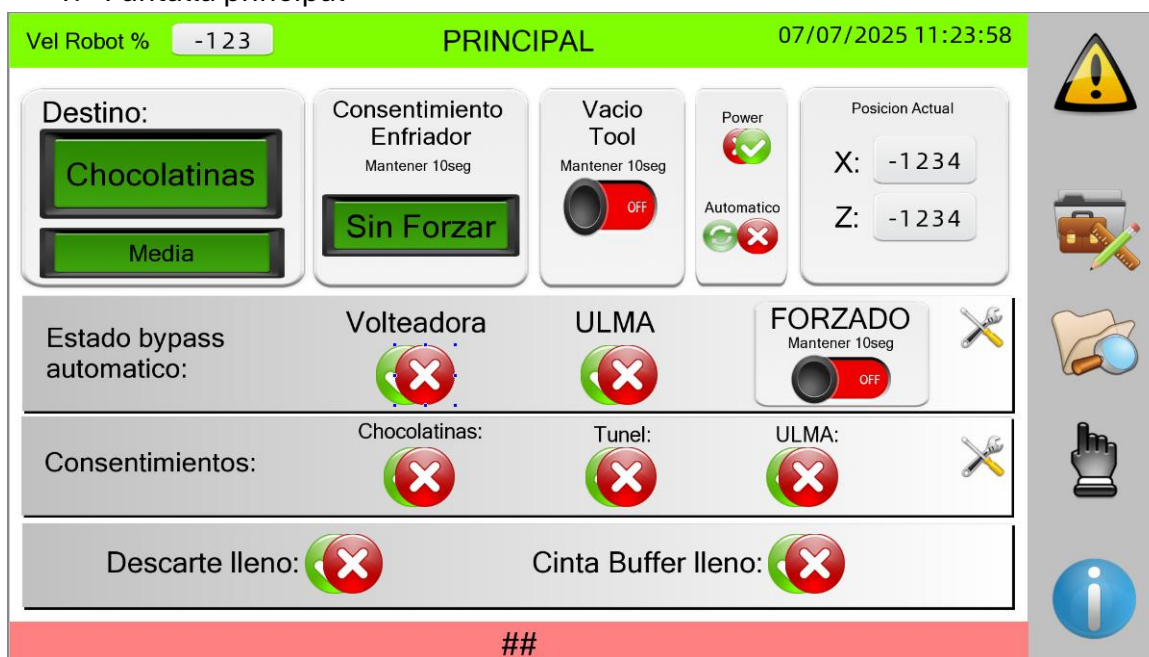
Ilustración 4. Pantalla principal HMI
