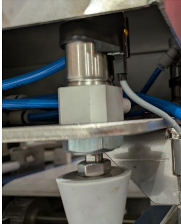
Fotografía 7. Sensor Festo SMT-8M-A
