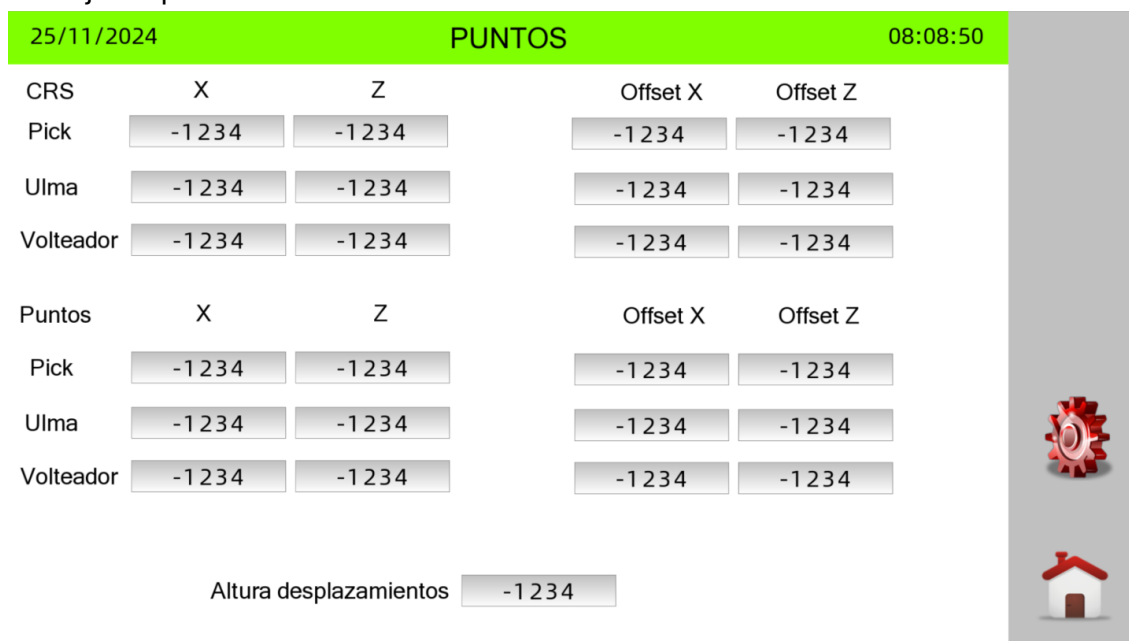
Ilustración 9. Pantalla Conf. pts control
