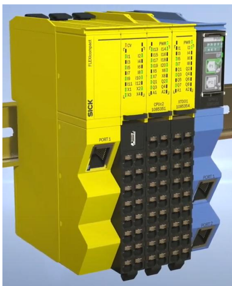
Ilustración 3. SICK FLX3-CPUC100+ modulo EtherCat
