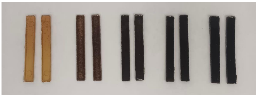
Figura 22. Probetas con diferentes concentraciones de carga tras el curado
