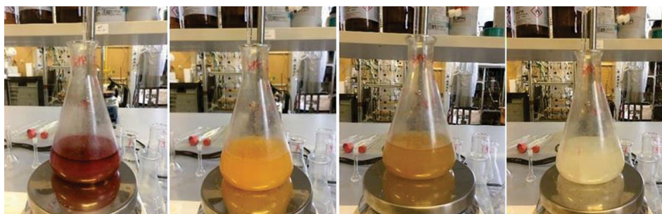
Figura 21. Variación de tonalidad del aceite durante la valoración del índice de yodo
