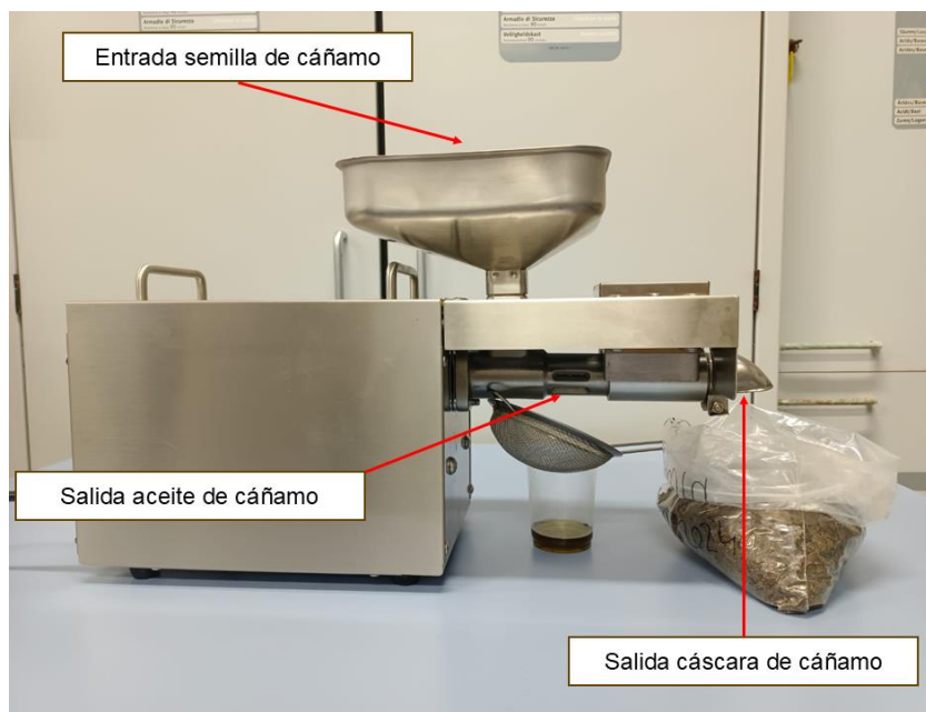
Figura 14. Partes de la extrusora de prensado en frío
