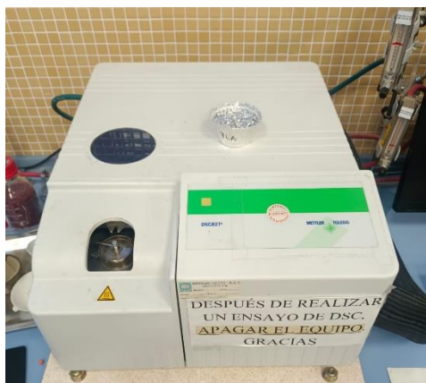
Figura 23. Equipo DSC Mettler-Toledo 821
