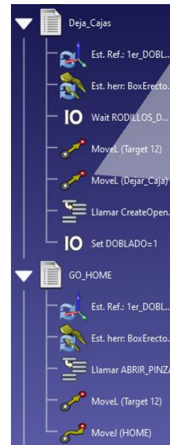
Ilustración 72. Programas estación de doblado 4 1ª versión.
