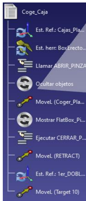
Ilustración 70. Programas estación de doblado 2 1ª versión.
