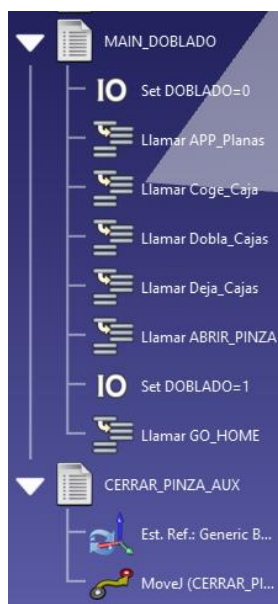
Ilustración 74. Programas principales de la estación 1ª versión.
