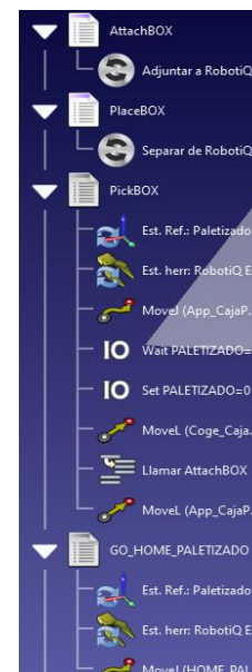
Ilustración 75. Programas estación de paletizado 2 1ª versión.
