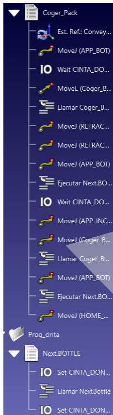
Ilustración 80. Programas estación de "Pick and Place" 2ª versión.
