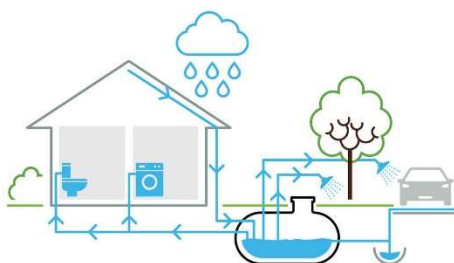
Figura 31. Recuperación agua de lluvia. 2025. Fuente: premiertechaqua.com
