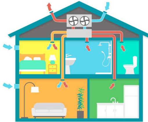
Figura 28. Ventilación mecánica de doble flujo. 2025. Fuente: manoamano.es
