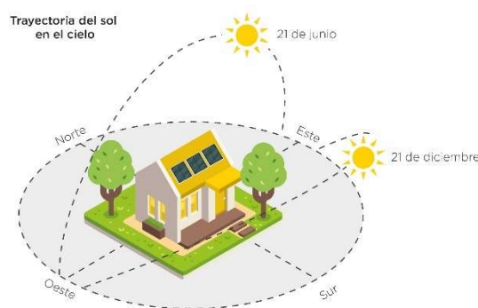
Figura 24. Trayectoria solar. 2024. Fuente: solarprofit.es
