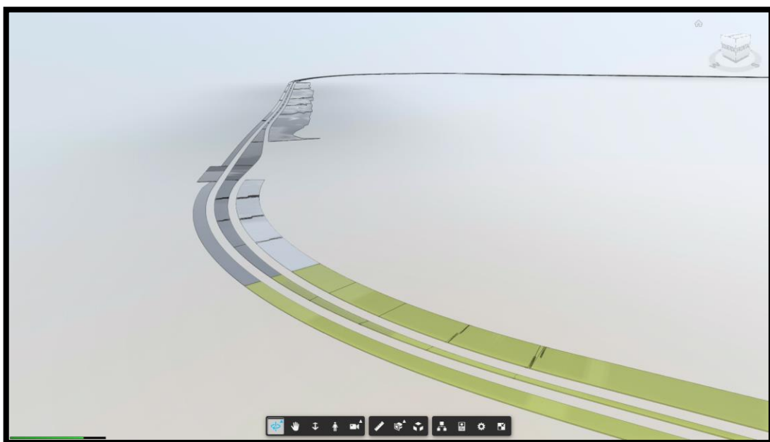
Figura 11. Modelado de pavimentación
