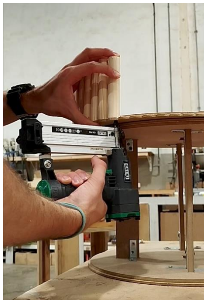
Ilustración 38: Clavado de los listones redondos
