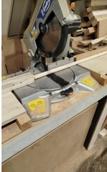
Ilustración 32: Corte de los listones mediante ingletadora
