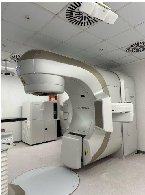
Figura 1: Acelerador lineal (LINAC) utilizado en radioterapia para la administración del tratamiento y adquisición de imágenes. Este acelerador es un TrueBeam de Varian Medical System, Palo Alto, CA con multilaminas Millennium.
