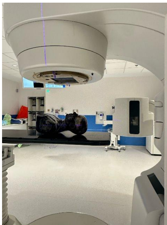
Figura 7: Adquisición de imágenes iCBCT del maniquí antropomórfico ALDERSON.
