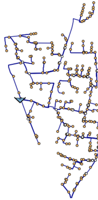
Figura 21. Topología de la red con reubicación del cabezal.
