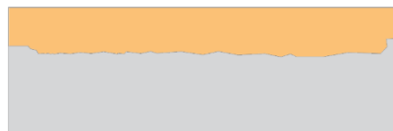
Figura 2. Corrosión uniforme. 2025. Fuente: Elaboración propia.
