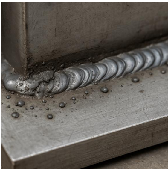
Figura 14. Cordón de soldadura sin preparar. 2025. Fuente: Elaboración propia.
