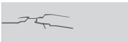
Figura 7. Corrosión bajo tensión. 2025. Fuente: Elaboración propia.
