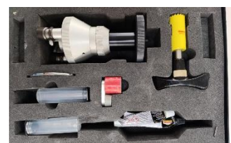
Figura 33. Pull-Off. 2025. Fuente: Elaboración propia.
