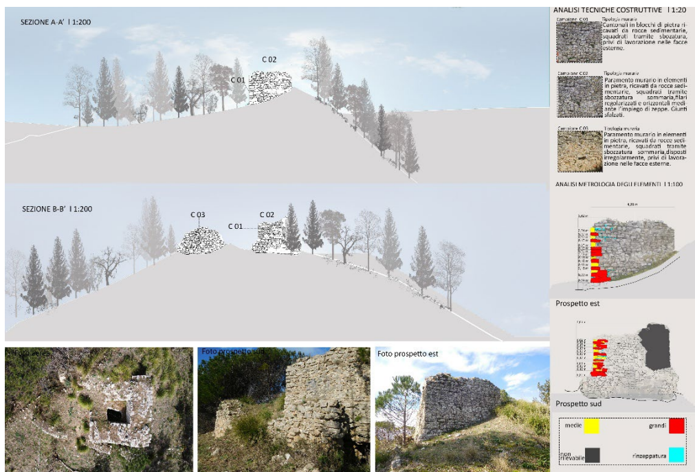
Fig. 5 - Restituzione in alzato della Torre degli Uberti. Nella colonna a destra, sintesi delle principali tecniche costruttive e schemi di sintesi metrologici e stratigrafici (elaborazione grafica elaborazione grafica di Filippo Pirrera, 2024).
