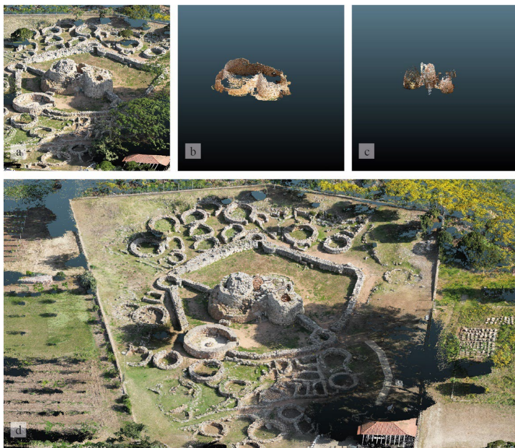
Fig. 5- Elaborazione dei rilievi fotogrammetrici - a. nuvola di punti da foto drone; b. nuvola di punti da macchina fotografica; c. nuvola di punti da action cam 360°; d. unione delle singole nuvole.
