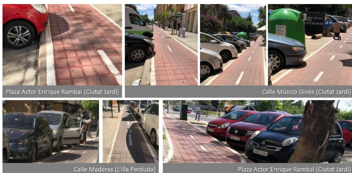
Figura 65. Proximidad de los aparcamientos a la infraestructura ciclista. Fuente: Propia
