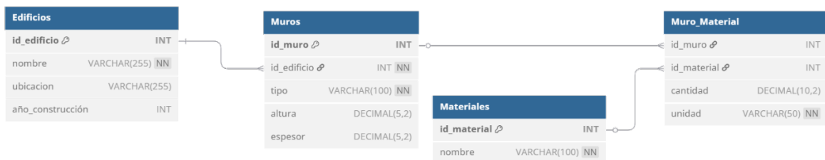
Figura 4.2: Esquema de base de datos relacional de edificios, muros y materiales (elaboración propia).
