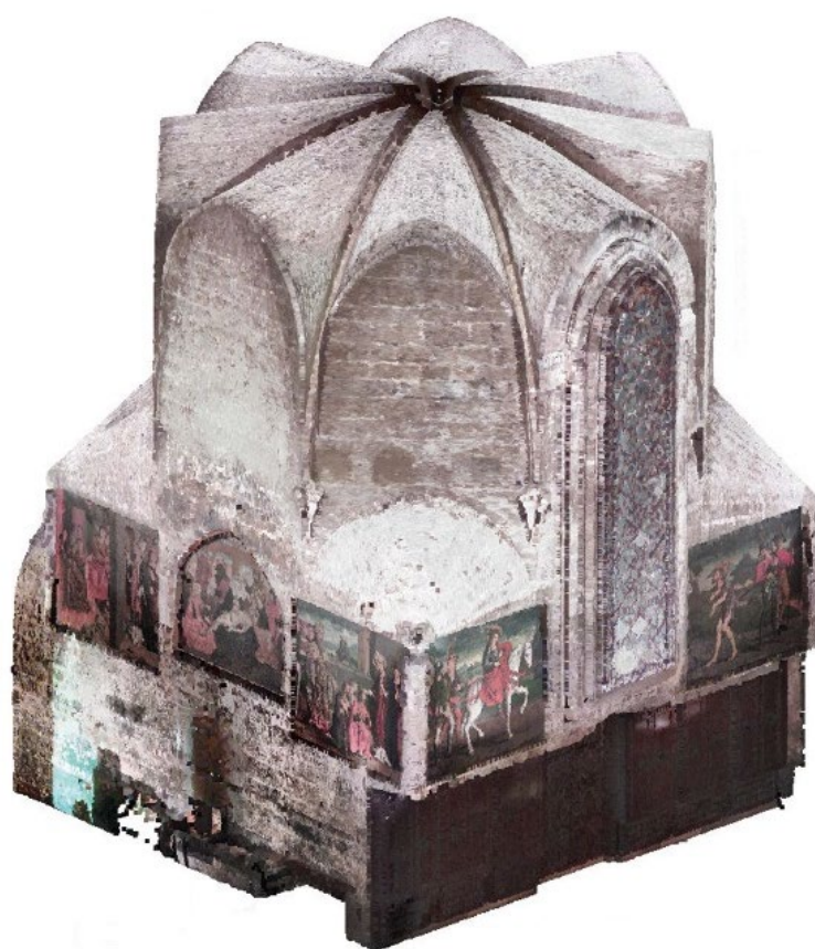
Figura 7.19: Nube de puntos de 47.073.944 puntos del sector de la Sacristía Mayor de la Catedral de Valencia (elaboración propia).
