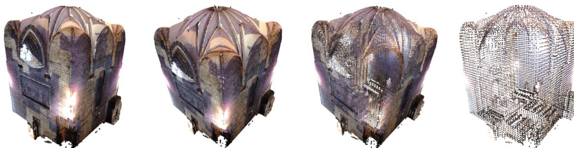
Figura 6.7: Submuestreo de la nube de puntos del interior de la Capilla del Santo Cáliz de la Catedral de Valencia (elaboración propia).
