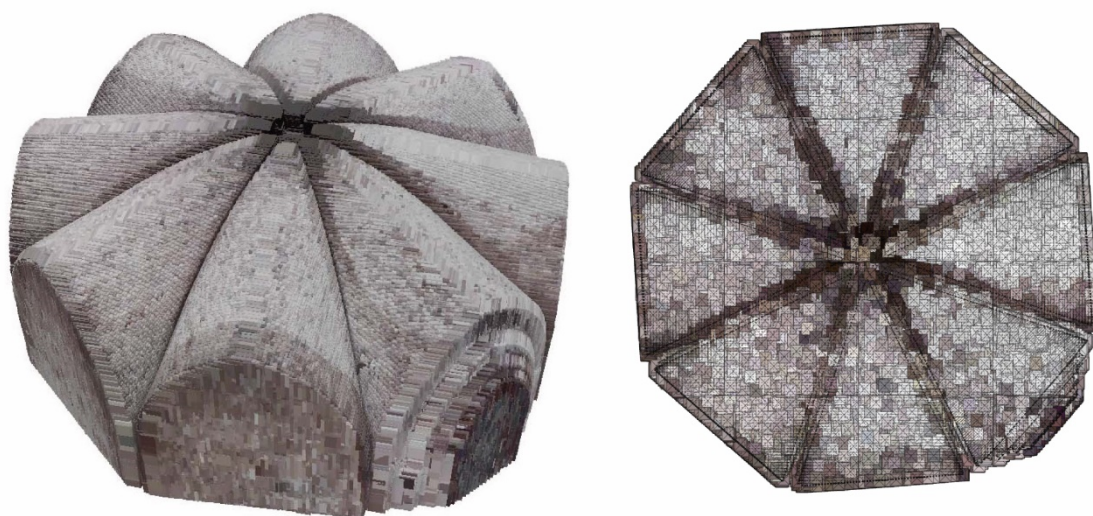
Figura 7.29: Visualización del modelo en Esri ArcGIS Pro utilizando la nube de puntos de la bóveda y el modelo IFC (elaboración propia).
