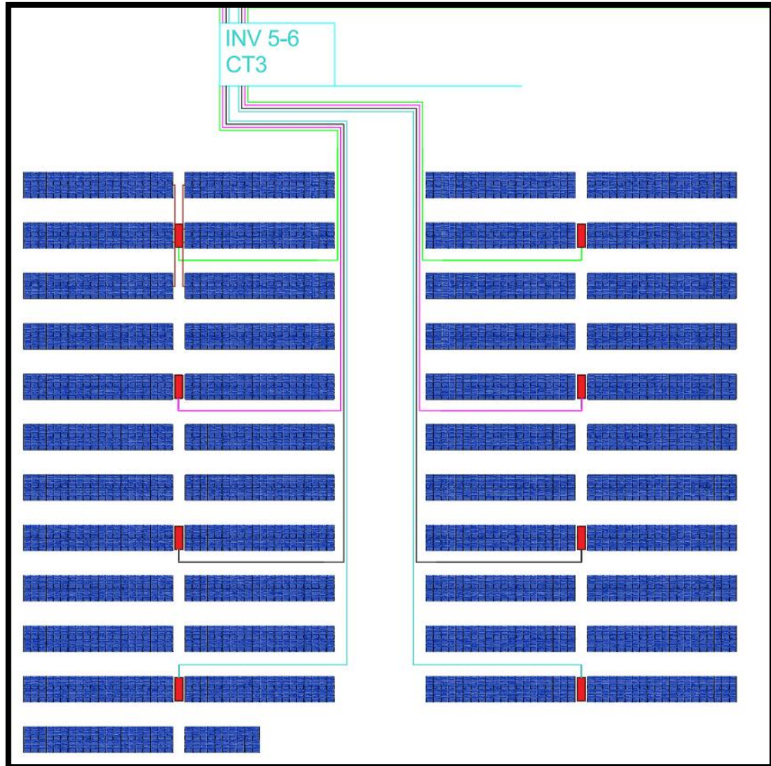
Figura 15. Distribución de un grupo inversor.
