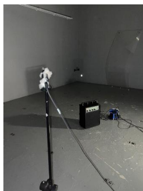
Imagen 7: Mediciones de potencia acústica en cámara reverberante con fuente de referencia
