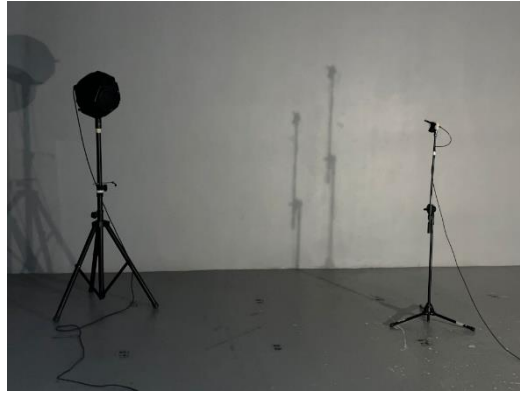
Imagen 3: medición del TR e la cámara reverberante de la EPSG
