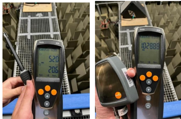
Imagen 10: Medición de presión atmosférica, temperatura y humedad relativa en la cámara anecoica de la EPSG el 12-4-24
