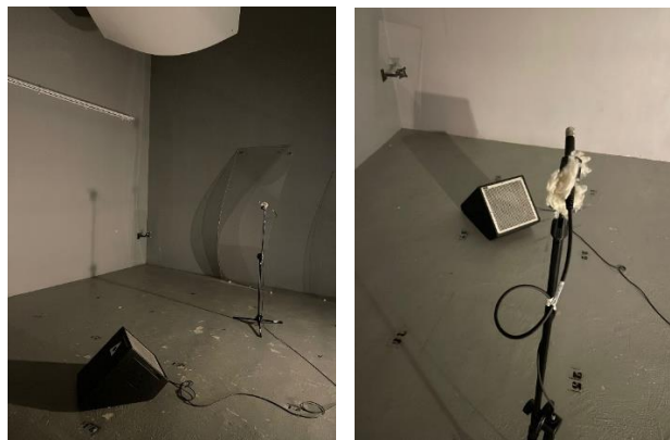
Imagen 4: Mediciones de potencia acústica en cámara reverberante
